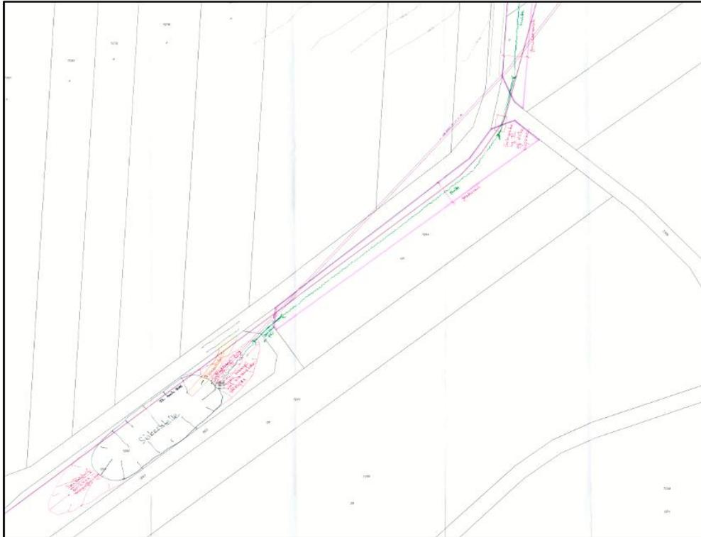
**Abb. 2: Planskizze mit Lage der bestehenden Versickerungsmulde südlich des Erweiterungsgebiets mit geplanter Erweiterung der bestehenden Versickerungsmulde, bestehender Wasserleitung DN 600 (violett) sowie geplanter Erweiterung des ableitenden Muldensystems (grün); eingenordet (o.M.); verändert nach [1.3].**
